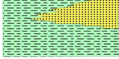
Şekil 1: "düşey bir stratigrafik istifte üst üste gördüğümüz fasiyes ve fasiyes topluluklarının, çökeltme zamanları içinde yan yana çökelmiş fasiyeslerdir" Bu ifade Walthers kuralı olarak bilinir.
