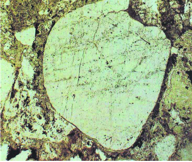
Killi bir kumtaşı içerisindeki yuvarlanmış bir kuvars kristali. İçerisinde bol miktarda sıvı veya gaz kapanımı mevcuttur.
